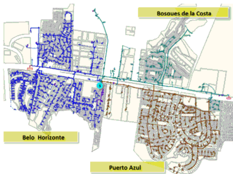
Figura 88. Alimentadores de suministro eléctrico: zona piloto.
