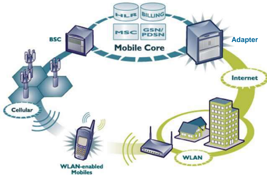
Figura 2.30. Acoplamiento WLAN – GSM/UMTS
