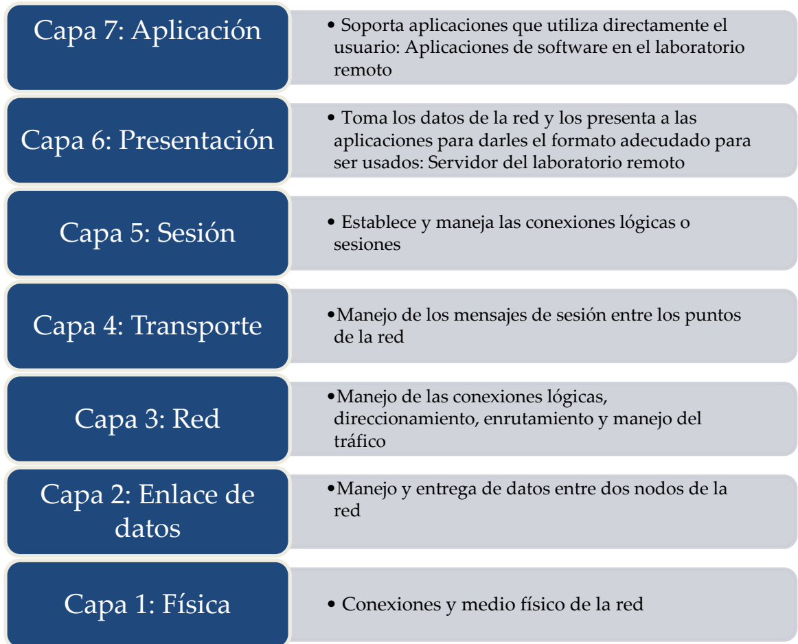
Fig. 25. Modelo de referencia OSI e integración del laboratorio remoto
