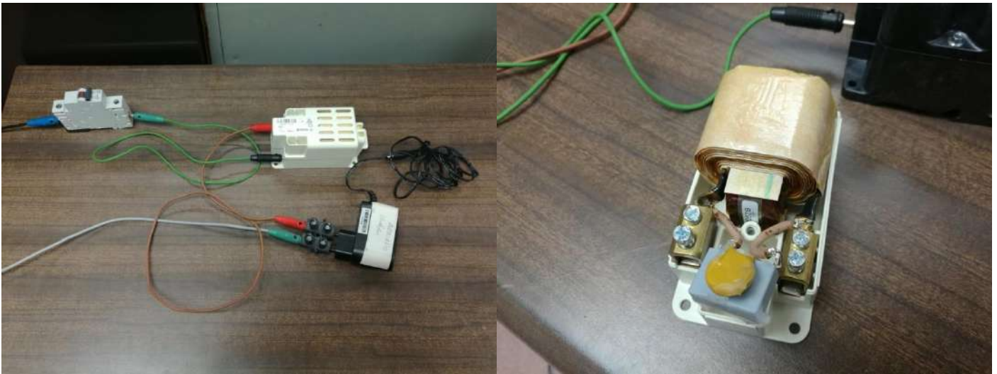
Figura 71. Conexión del filtro B en nuestro modelo experimental y muestra de su aspecto interior.
