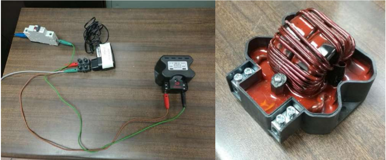
Figura 79. Conexión del filtro D en nuestro modelo experimental y muestra de su aspecto interior.
